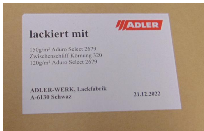
Abbildung 1: Muster 3.1 Etikette – Schichtaufbau
