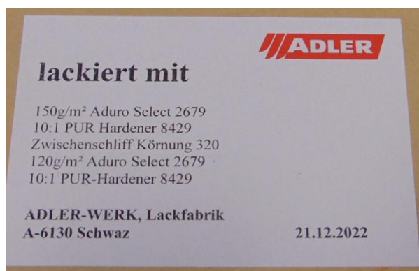
Abbildung 1: Muster 3.1 im Etikette – Schichtaufbau
