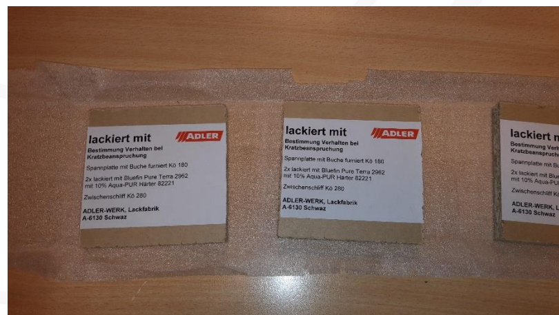
Abbildung 2: Rückseite der Prüflinge mit beschriebenem Schichtaufbau
