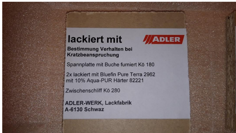
Abbildung 1: Rückseite eines Prüflings mit beschriebenem Schichtaufbau
