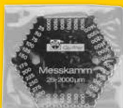
Praktisches Tool zur Bestimmung der Schichtstärke von Nassfilmen (z. B. Dickschichtlasuren). Messbar ist die Schichtstärke zwischen 25-2000 µm.
