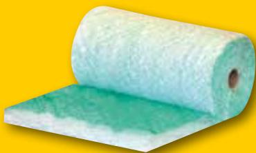
Der Filter besteht aus einem Hochleistungsvliesstoff und ist so aufgebaut, dass er ein Optimum an Filterleistung und Staubspeichervermögen bei niedriger Druckdifferenz erreicht. Die Matte ist haftaktiv und bietet Sicherheit gegen Staubburchbruch.
