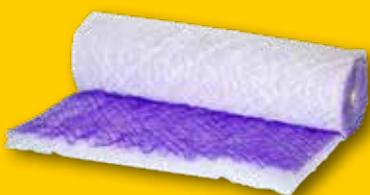
Hochwertiger Filter speziell für die Filtration von wasserbasierten Lackpartikeln in Spritzkabinen. Der Flächenfilter garantiert einen hohen Abscheidegrad bei gleichzeitig tiefem Druckverlust. Dies wird durch seine äußerst feinen, sehr elastischen Glasfasern ermöglicht. Maße: 1 m x 20 m.
