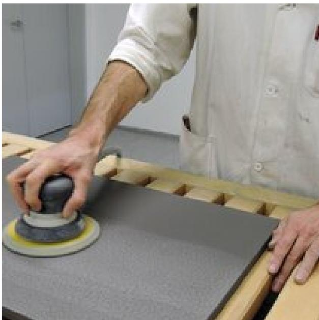
Den gefüllerten, trockenen Untergrund dann direkt vor dem Lackieren mit Körnung 240 anschleifen.
