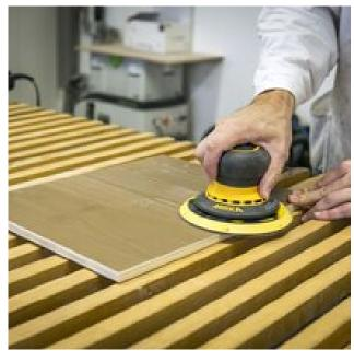
Für den Bronze-Effekt auf der gebürsteten Fichte muss das Holz stark gebürstet werden. Dadurch wird eine strukturierte Oberfläche erzielt, bei der die Maserung voll zur Geltung kommt. Auch hier wird im Anschluss PUR-Ecofill Weiß als Füller verwendet und die getrocknete Oberfläche direkt vor dem Lackieren einmal mit Körnung 240 und nochmal mit einem Schleifvlies angeschliffen.
